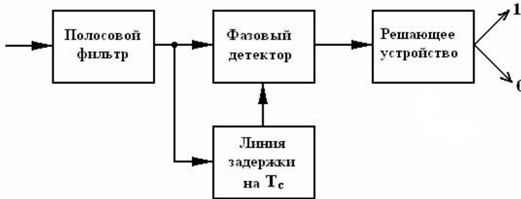
Рисунок 9.6 - Структурная схема приемника ОФМ сигналов по методу сравнения фаз
