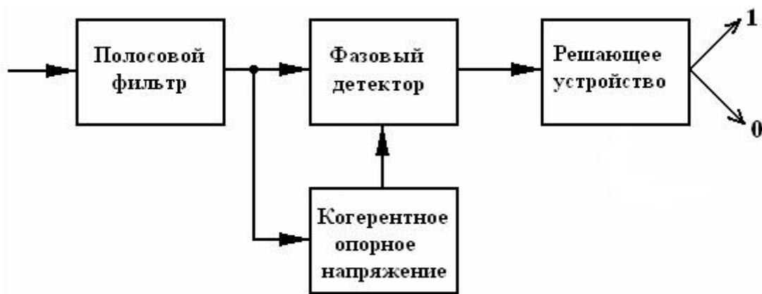
Рисунок 9.5 - Структурная схема приемника ФМ сигналов
