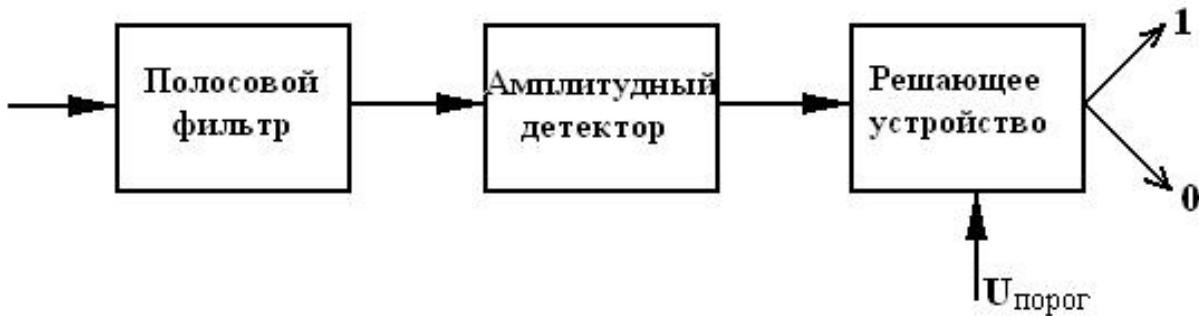
Рисунок 9.1 - Структурная схема некогерентного приемника АМ сигналов
