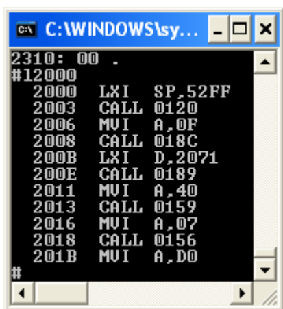
Рис.4.12. Дизассемблирование по команде L, начиная с адреса 2000h
