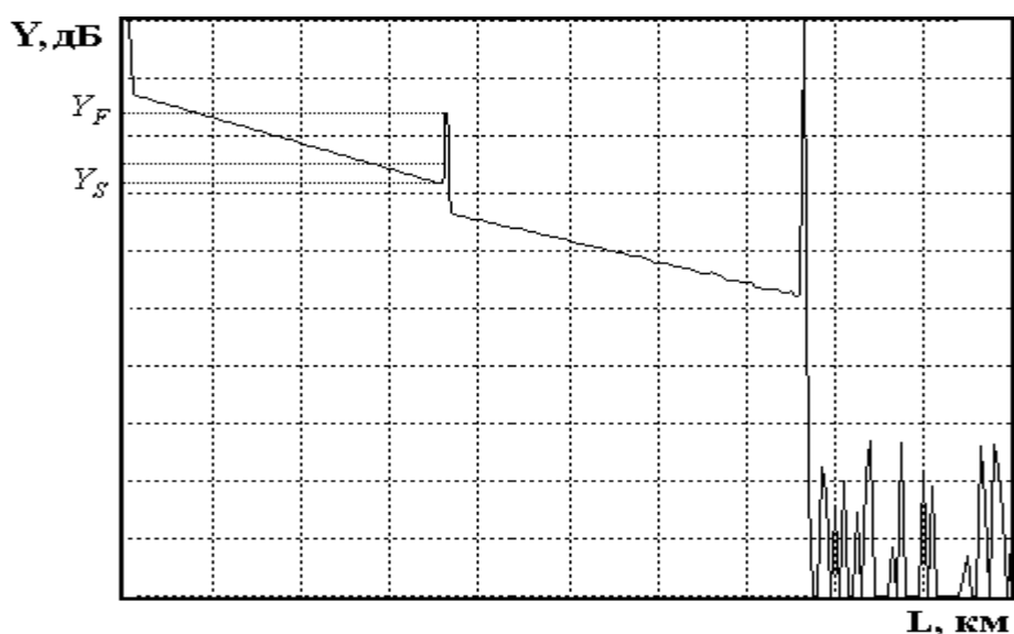
Рис. 3.3. Методика измерения возвратных потерь
