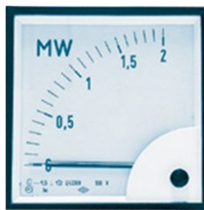
Рис. 2. Мегаваттметр класс точности 1,5
