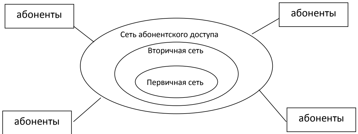
Рисунок 1- Иерархическая структура мультисервисной
