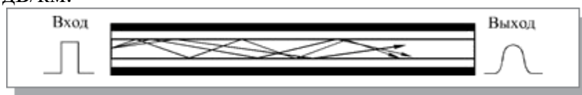
Рисунок. 1.5. – Распространение света в многомодовом кабеле
