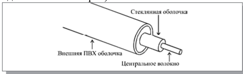
Рисунок. 1.3 – Структура оптоволоконного кабеля
